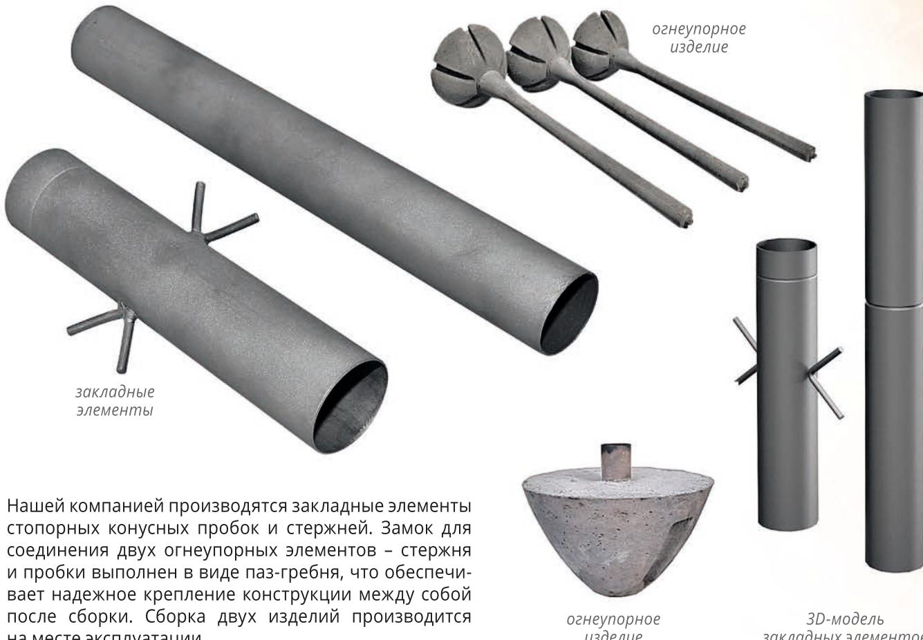
Нашей компанией производятся закладные элементы стопорных конусных пробок и стержней. Замок для соединения двух огнеупорных элементов – стержня и пробки выполнен в виде паз-гребня, что обеспечивает надежное крепление конструкции между собой после сборки. Сборка двух изделий производится на месте эксплуатации.
